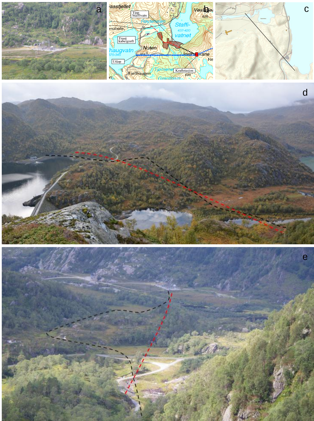
Figur 2. (a) Eksisterende koblingsanlegg Blåfalli III, (b) Kabeltrase og (c) Luftledning. Landskapsbilder over aktuelt område med trase for kabel (sort stipling) og luftlinje (rød stipling). Bilde (d) viser området
