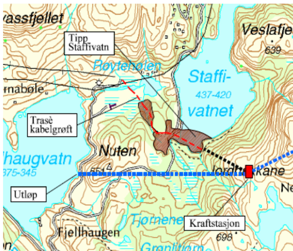
Figur 3. Kabeltrasé fra Blåfalli Fjellhaugen kraftverk til koblingsanlegg Blåfalli III.
