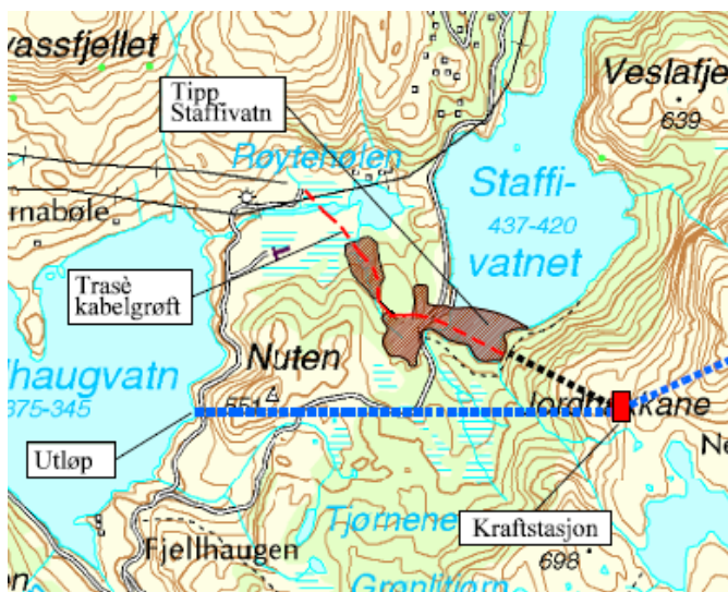
Figur 2 Kabeltrasé fra Blåfalli Fjellhaugen kraftverk til koblingsanlegg.
