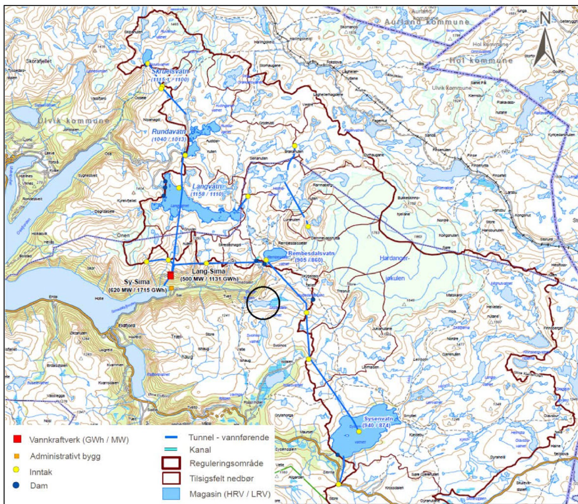
Figur 2.3. Deler av reguleringen til Sima ( www.statkraft.no ). Inntak er merket med gult, tunneler blått og vannkraftverk rødt. Et større nedbørfelt i sør (utenfor kartet) blir også ført til Sy-Sima kraftverk. Skytjedalsvatn er merket med svart sirkel.
