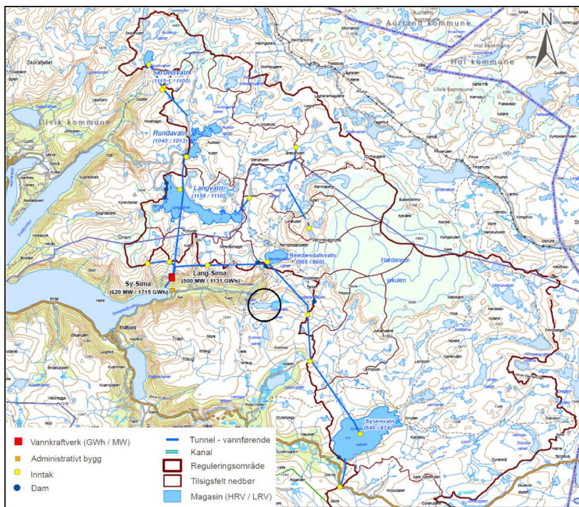
Figur 2.3. Deler av reguleringen til Sima ( www.statkraft.no ). Inntak er merket med gult, tunneler blått og vannkraftverk rødt. Et større nedbørfelt i sør (utenfor kartet) blir også ført til Sy-Sima kraftverk. Skytjedalsvatnet er merket med svart sirkel.
