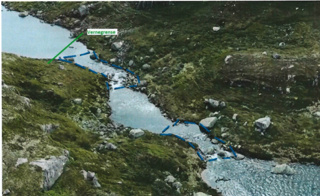
Figur 5: Normalt bekkeløp med aktuelle områder for opprensning og utvidelse markert med stiplet linje (alternativ 2).
