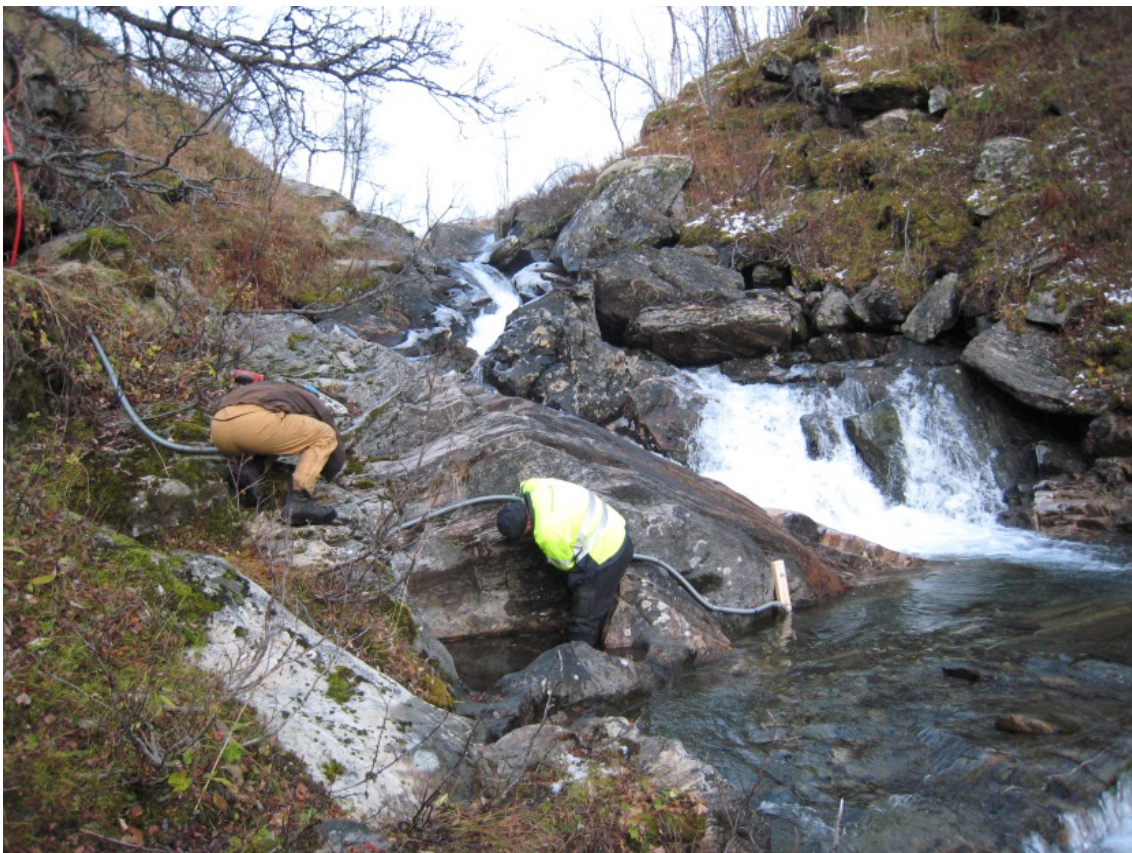
Bilde 9 Etablering av vannlogger. Vannføring: 0,29 m 3 /s (Tinfos, 11.10.2011).
