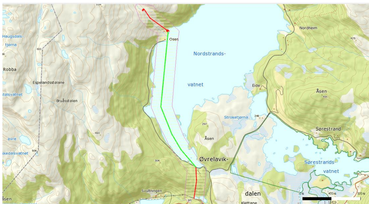
Figur 7. Kartutsnittet viser dei viktigaste naturinngrepa som skal gjerast innan utbyggingsområdet, dvs inntak, røyrgate, tilknytingskabel (den grøne lina er sjøkabelen) og kraftverk. Normalt er det rekna ei sone på ca 100 m til kvar side av inngrepet som influensområde. Dette området er markert med lilla line og gul skravering. Dette er likevel ei tenkt grense som av og til kan påverka sterkt fuktkevjande kryptogamar og då helst i slutta skog. I ope terreng er ikkje det reelle influensområdet særleg breiare enn sjølve inngrepet. For einskilde fuglar kan influensområdet vera opptil 1000 m. Kartet er henta frå GisLink.
