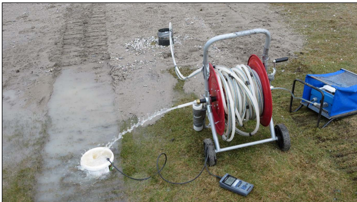
Figur 5. Pumping med uttak av vannprøver og måling av grunnvannets temperatur og ledningsevne (mai 2013).
