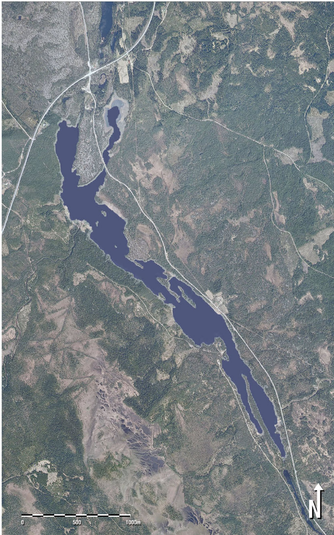
Figur 3.2. Vanddekt areal for A451 ved vannstand på kote 450,50 (LRV) og tørrlagt sone (grå sone langs vannkanten) opp til HRV på kote 451,00. Kilde: Multiconsult 2014.
