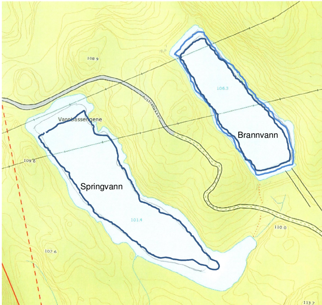
Figur 4: Skisse som viser anslått strandlinje etter senkning av vannspeil. For Brannvann vises vannstand etter tiltak, etter tiltak som allerede er gjennomført etter avtale med NVE damtilsynet og vannlinjen slik den har vært de siste årene (siden aktiv regulering av magasinene opphørte).
