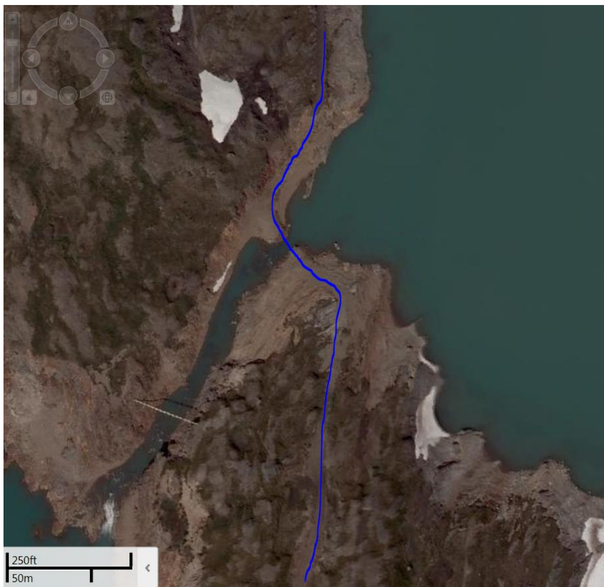
Figur 14 – Blå strek viser kabeltrasé der den krysser Rundvass-straumen. Over Rundvasstraumen vil kabel støpes inn slik at vann fra Rundvatnet ved alle vannstander i Sisovatnet vil renne over den innstøpte kabelen. På bildet vises en gangbro. Denne er tidligere tatt av flom/Jøkullaup, men bygget opp igjen.
