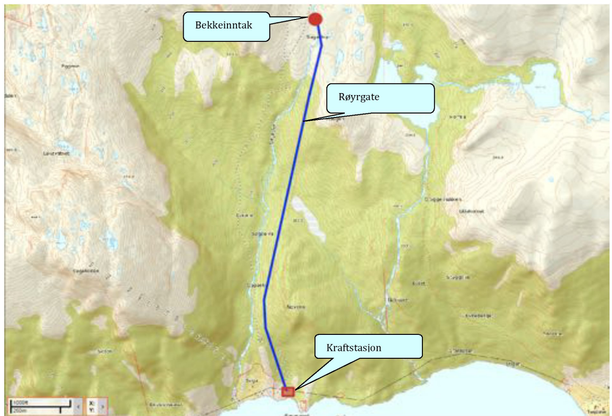
Figur 3. Kartutsnittet viser i grove trekk dei viktigaste naturinngrepa i form av inntak, røyrgate og kraftstasjon.
