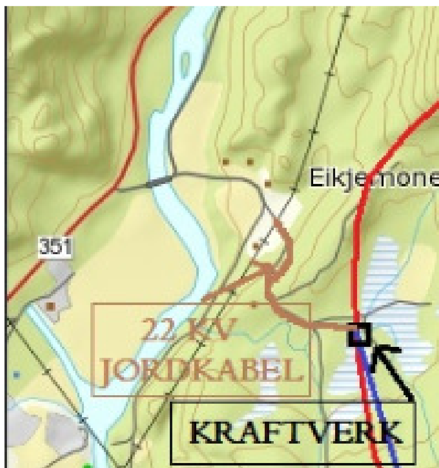
Figur 9 Inntegnet trase strømpåkobling
