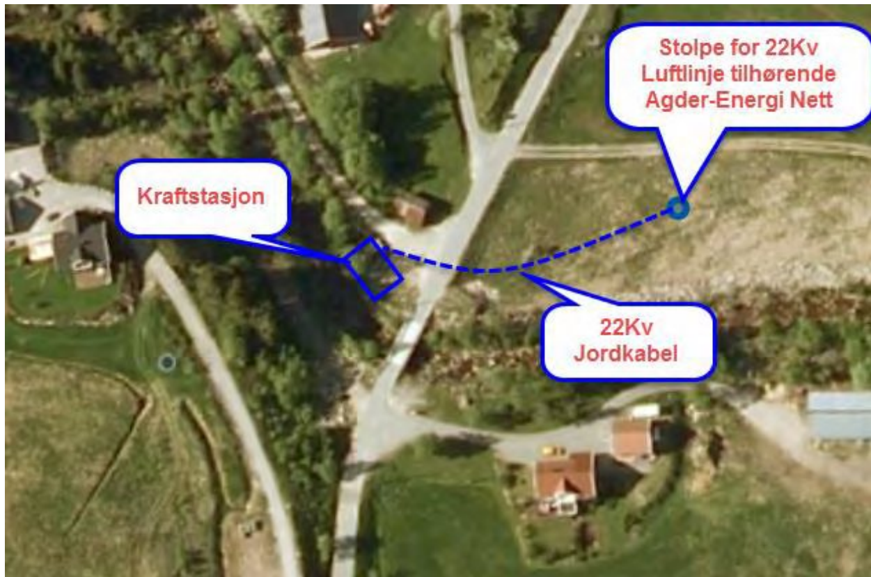
Fig 3.12.1.2. Flyfoto. Traséen for nedgravd høyspentkabel fra kraftstasjon og til eksisterende høyspent linje
