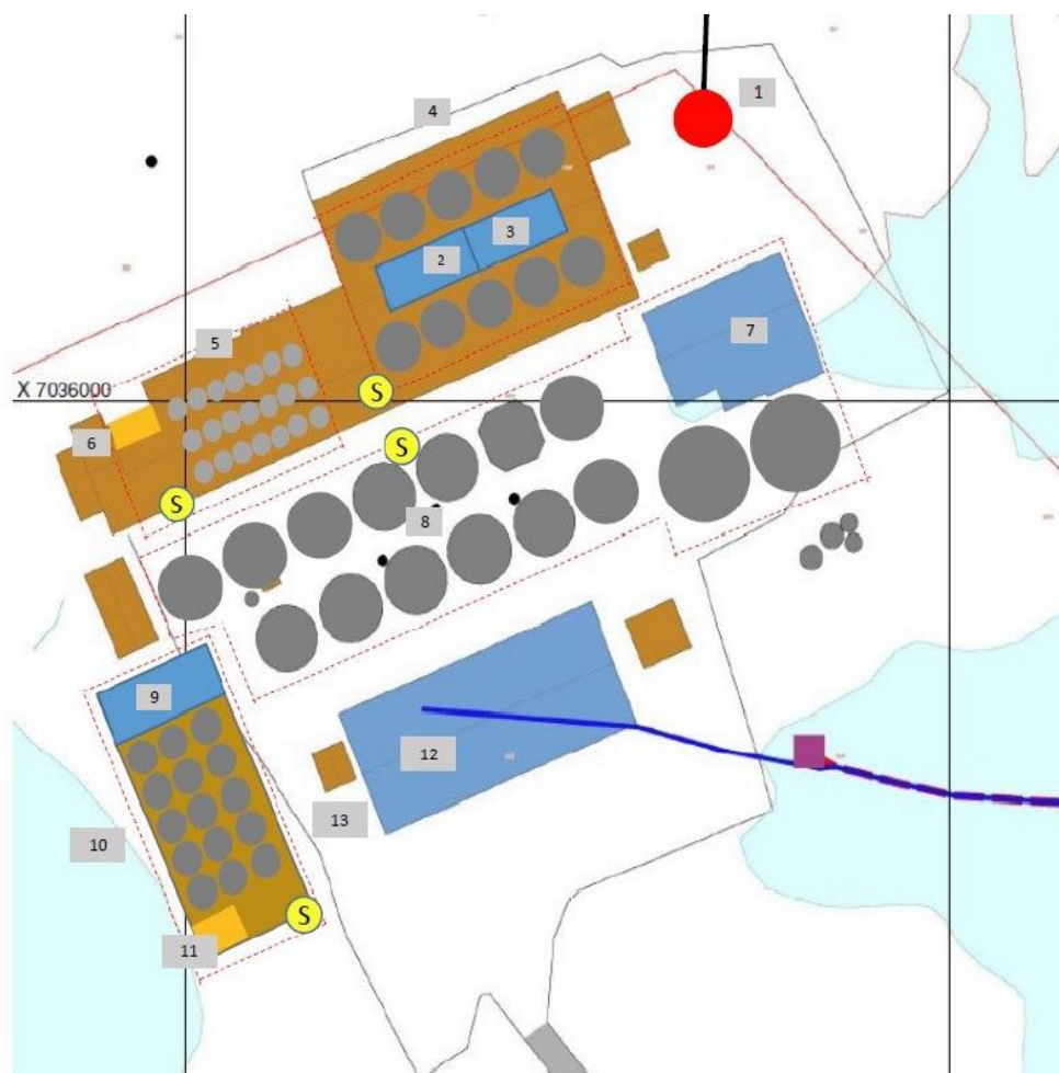
Figur 4: 1). Slamavskiller / End of pipe biogassreaktor. 2). Biofilter 1 i Smøla 2. 3) Biofilter 2 i Smøla 2. 4) Smøla 2 avdeling påvekst. 5). Smøla 1 – startfôring. 6). Klekkeriavdeling i Smøla 1. 7). Biofilter i Smøla 3. 8). Smøla 3 – påvekstavdeling utendørs. 9) Biofilter i Smøla 4. 10). Smøla 4. ny startfôringsavdeling. 11). Klekkeri i Smøla 4. 12). Administrasjon og verksted. 13). Sluse for besøkende. Vannbehandlingsteknologi installert i biofilteravdelingene er basert på trommelfilter 50 \mu\text{m} ), UV, ozonering og proteinskimmer (<50 \mu\text{m} ).
