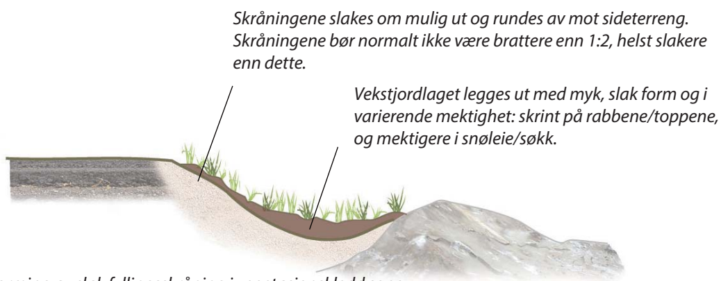
Utforming av slak fyllingsskråning i vegetasjonskledd sone
