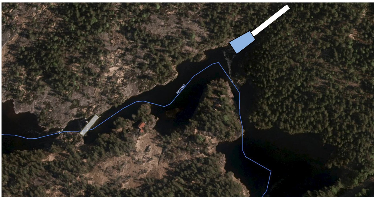
Figur 2.8 Illustrasjon som viser område for planlagt terskel med overløp.
