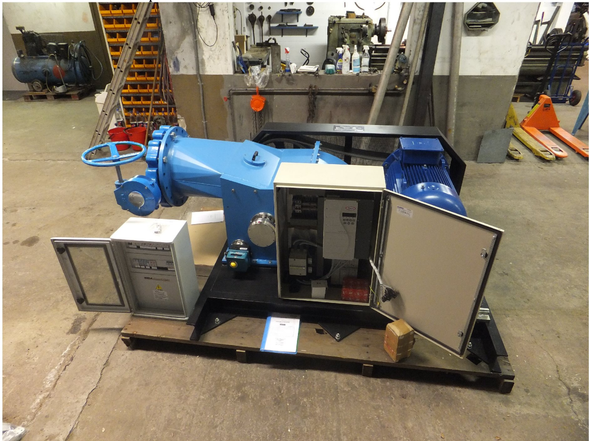
Bilde 4. Foto Fossingraft AS Tverrstrømturbin med asynkrongenerator levert av Fossingkraft AS
