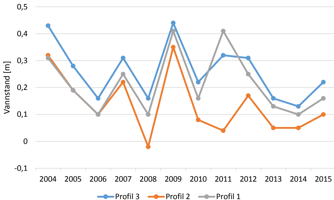
Figur 12. Differansen mellom gytevannstand (median ukemiddel i gytetiden (oktober)) og vannstand i den påfølgende inkubasjonsperioden (laveste ukemiddel, oktober-mai) ved tre forskjellige tverrprofiler av Kåfjordselva (Profil1: 1456.715, Profil 2: 3930.303, Profil 3: 5074.268 i Sandsbråten & Magnell 2017).
