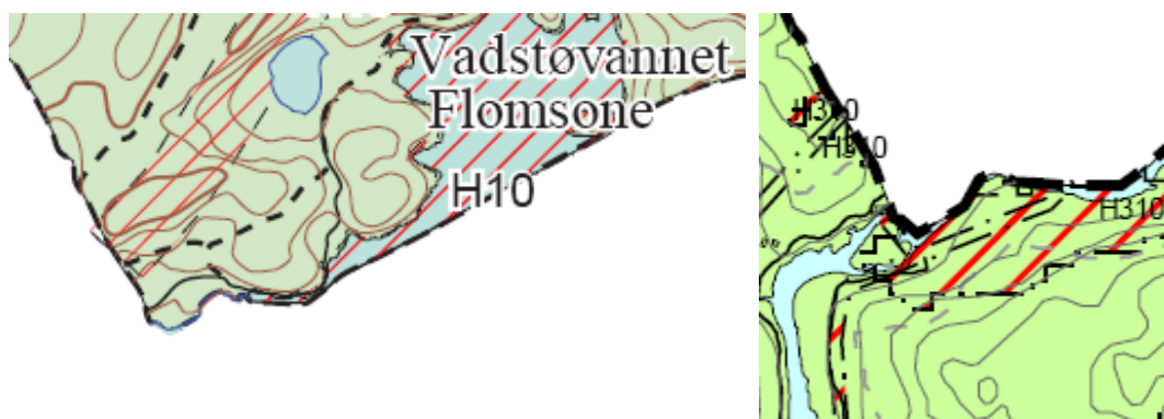
Figur 4-1. Venstre panel viser utsnitt av kommuneplanens arealdel (2011 – 2023) for Gjerstad kommune hvor planområdet er angitt som LNF, med en hensynsone med fare for flom skravert rødt i Vadstøvannet. Høyre panel viser utsnitt av kommuneplanens arealdel (2014 - 2025) for Risør kommune hvor planområdet er angitt som LNF-område, med en hensynsone med fare for ras skravert i rødt.
