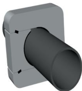
Figur 4-3. Typisk belastningslodd rundt ledning som brukes for å holde ledningen stabilt i grøft
