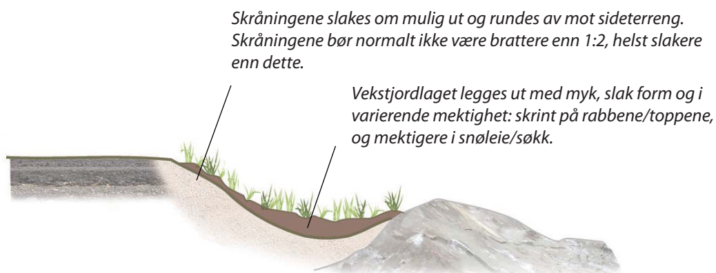
Utforming av slak fyllingskråning
