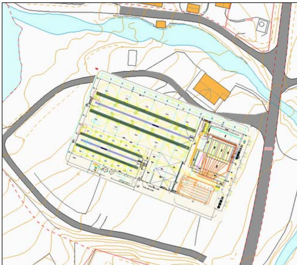
Figur 2. Fister Smolt AS henter sitt vann fra Hetlandsvatnet gjennom to ca 1300 m lange inntaksledninger ned til anlegget (til venstre). Avløpsvannet føres i dag ut gjennom to vel ca 200 m lange avløp på rundt 20 m dyp, og det planlegges et nytt ca 600 m langt sjøvannsinntak fra ca 80 m dyp (til høyre).
