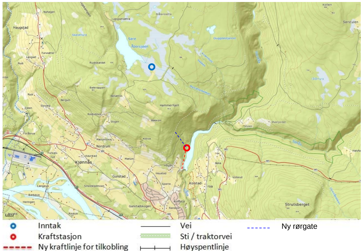
Figur 3 - Lokal plassering som viser veger, bebyggelse og 22 kV linjer. Inntak, stasjon og tilkobling er påtegnet. Kartkilde: Norgeskart, 2012.
