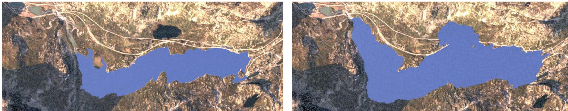
Figur 3. Bileta ovanfor syner neddemt areal ved HRV 1111 moh i høve dagens HRV på 1104 moh. Auke i neddemt a areal vert om lag 495 mål.
