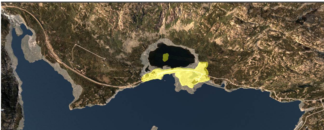
Figur 5-3. Bildet viser beregnet utfylt areal mellom Skiljebekktjørni og Tungevatnet ved oppfylling fra kote 1109. Dette utgjør et areal på 30.000m 2 og et massebehov på 65 000 m 3 .
