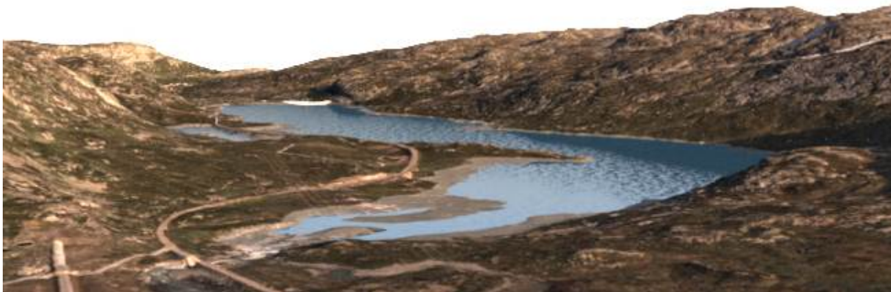
Figur 9-6. Bildet viser Tungevatn med HRV 1111 og LRV 1107. Tørrlagt areal er betydelig mindre enn ved LRV ved dagens reguleringsgrenser. Reguleringshøyden blir dobbelt så stor men likevel ikke dominerende i et landskap der mye av overflaten er bart fjell og ur.
