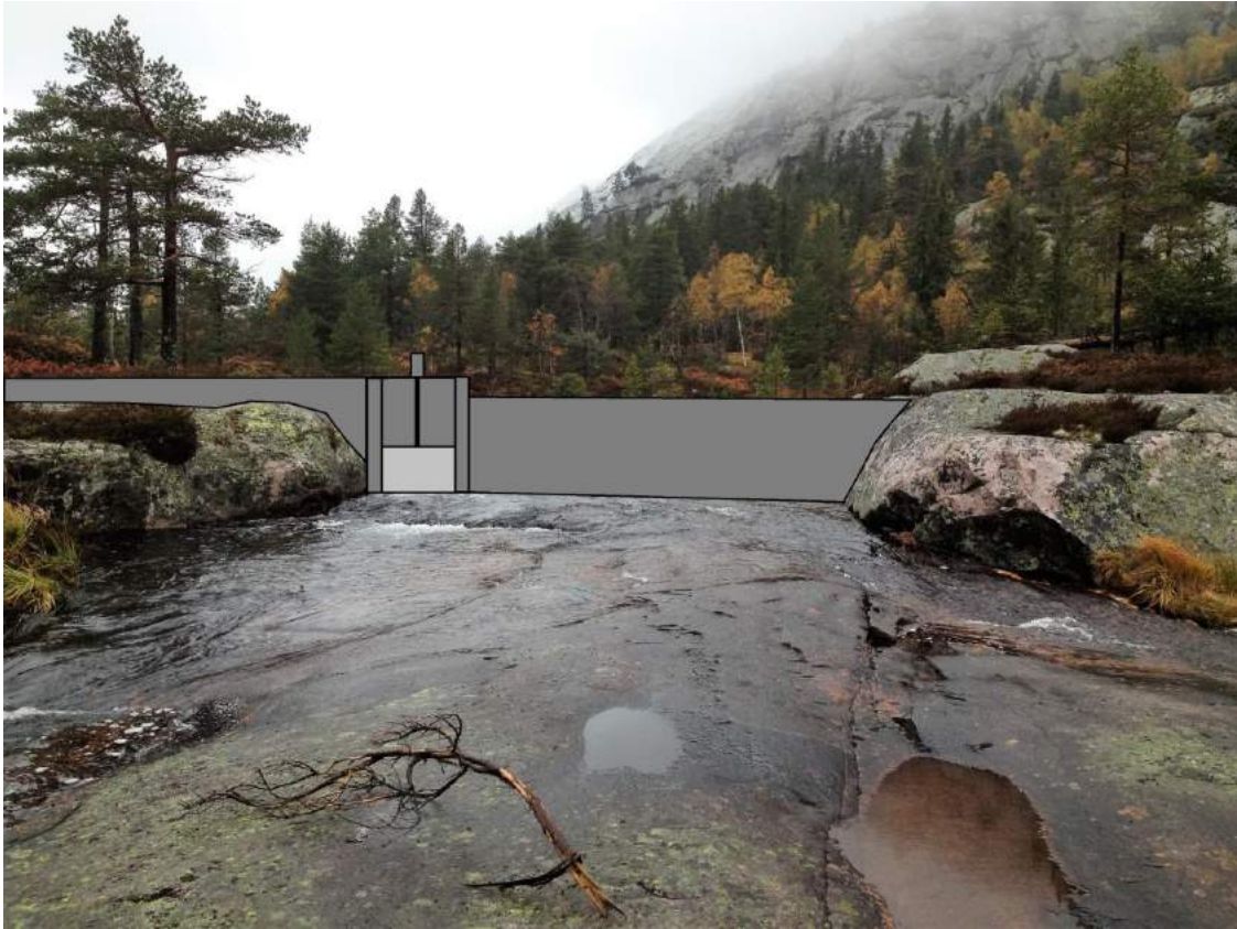
Fig 22. Tegnet dam i lona nedstrøms Steinsvatn med tappeluke.
