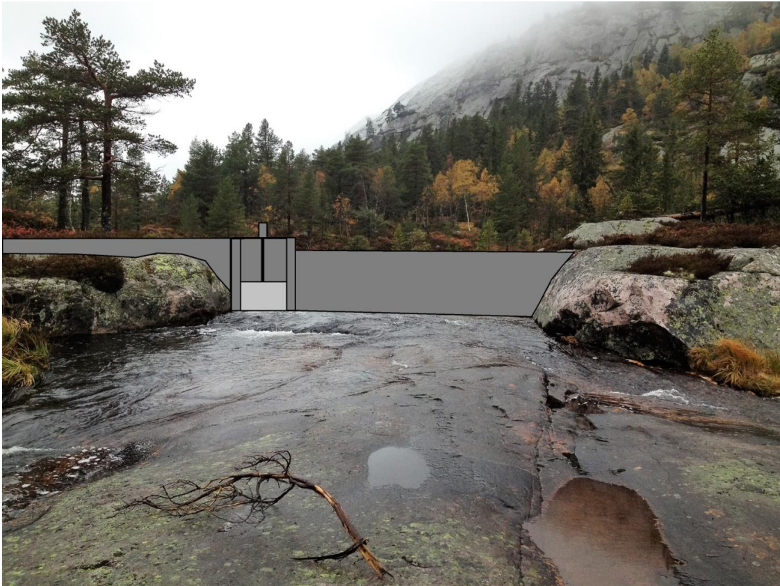
Tegnet dam i lona nedstrøms Steinsvatn med tappeluke.
