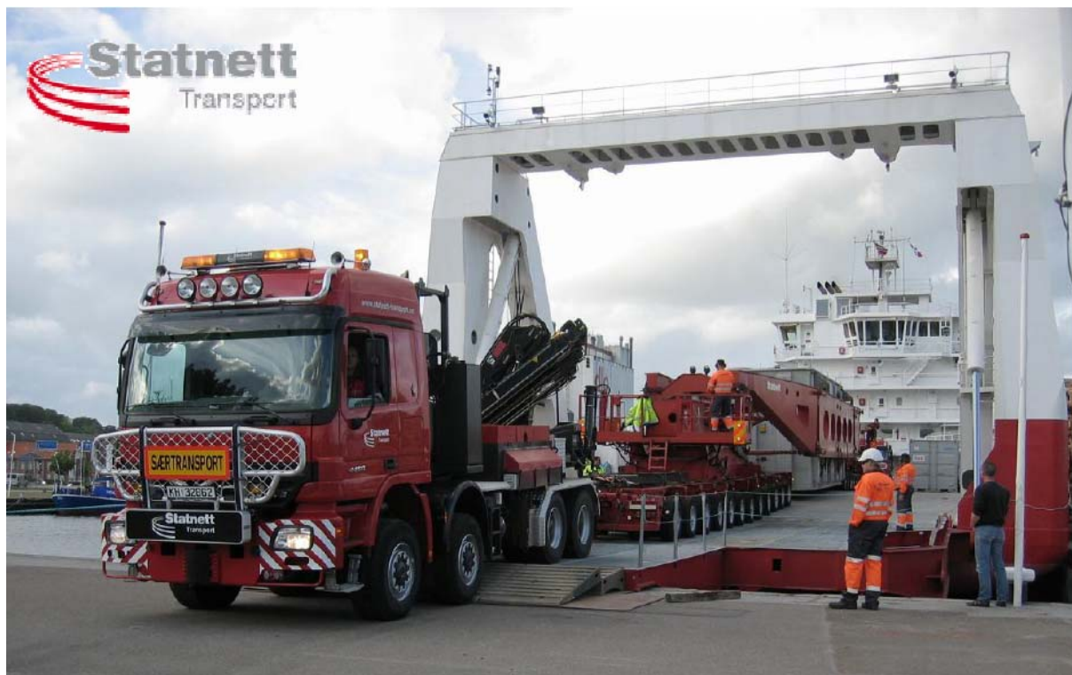
FIGUR 23: EKSEMPEL PÅ ILANDFØRING FRA RORO-SKIP, HER STATNETT TRANSPORTS'S MS ELEKTRON.
