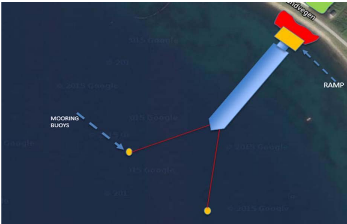
FIGUR 25: VED Å BENYTTE RORO-PRINSIPPET VIL EKSISTERENDE BETONGKAI VÆRE TILSTREKKELIG OG SKIPET KAN LIGGE MED BAUGEN UT I FJORDEN, SLIK PRINSIPPSKISSEN VISER.
