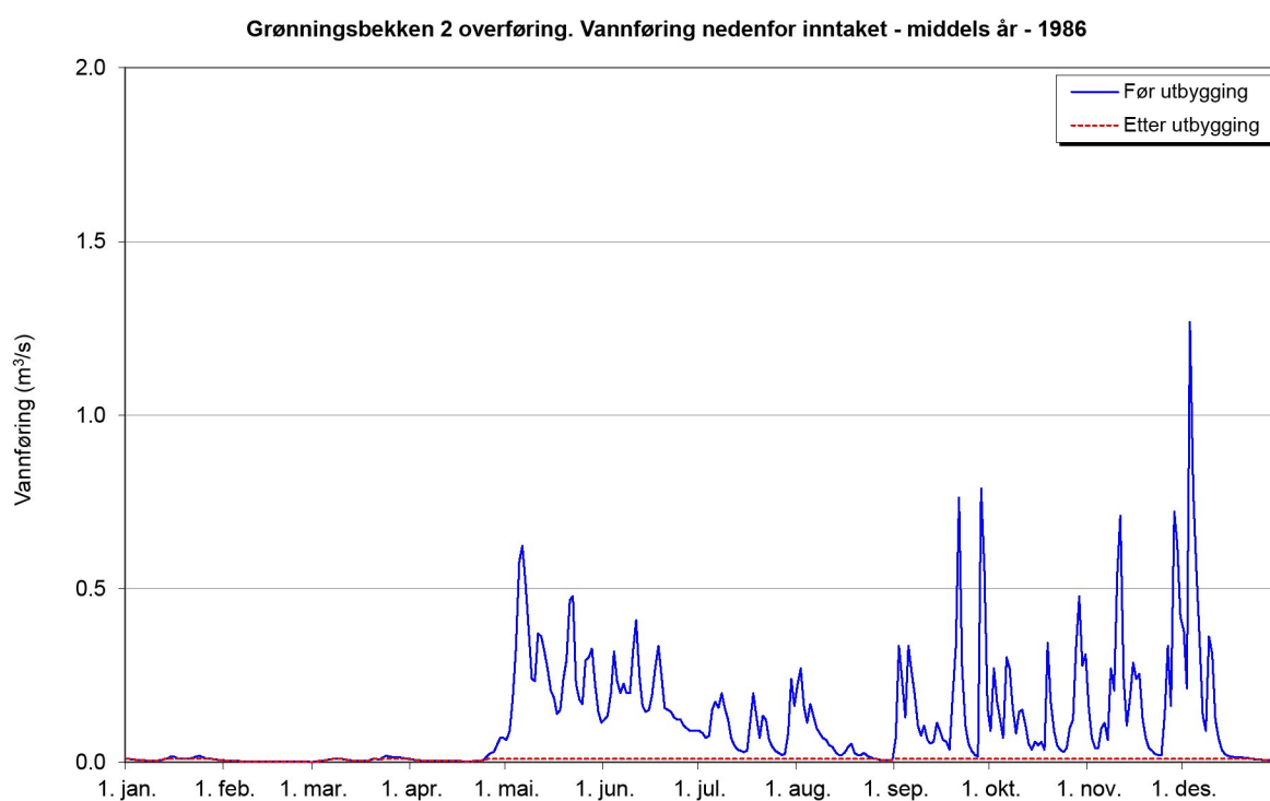
Figur 13 Vassføring ved inntak Grønningsbekken 2 i eit middels år.
