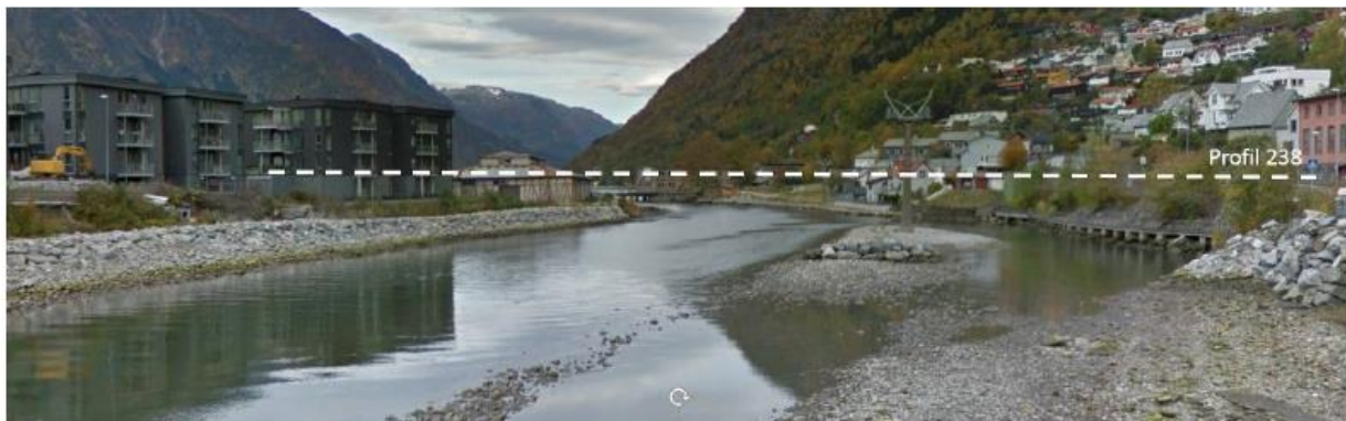
Figur 9.2 Nedre del av Opo. Stipla linje viser vasstand i Opo ved 1000-årsflaum med 40 % klimapåslag for profil 238 fra flaumsonekart vist i Figur 9.1
