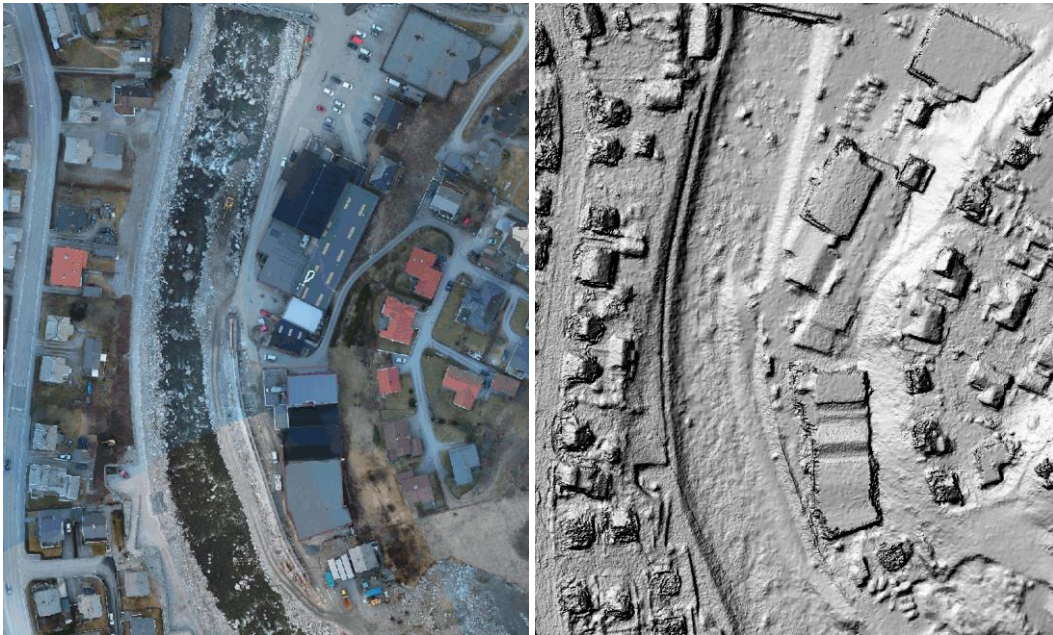
Figur 8-4. Dronebilde (til venstre) og tilhørende terrenngmodell (til høyre).
