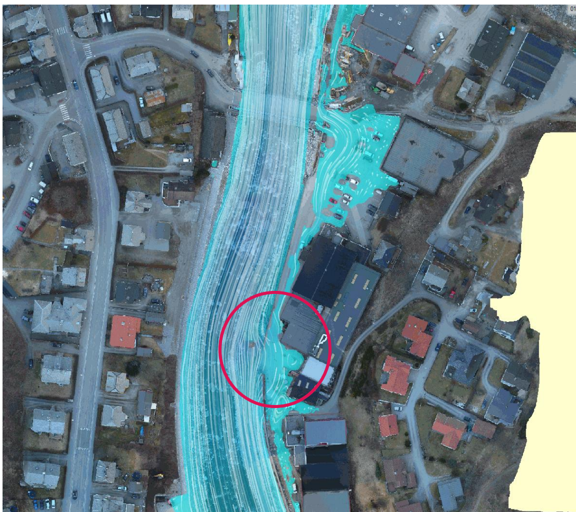
Figur 18 Overtopping av flomveggen ved 630 \text{ m}^3/\text{s} skyldes sannsynligvis restene av en kjørerampe i terrengmodellen
