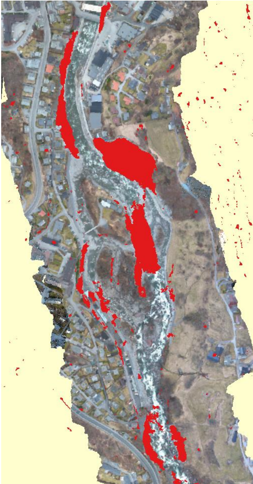
Figur 8 GIS analyse av terrengnivå i 2011 og etter flommen i 2014. Rødt betyr at terrenget hadde senket seg 1 m eller mer. For selve elveløpet og Elvevegen ved sykehuset og Hjøllo kan man tydelig se at terrenget er senket etter flommen. GIS analysen fanger også opp endringer i vegetasjonen, eksempelvis som man kan observere på sidene.
