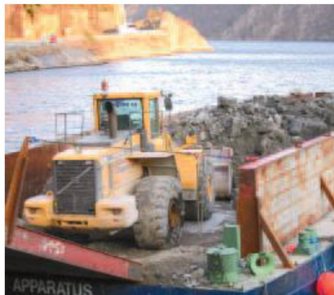
Figur 6 Lekter kan brukes som transportutstyr eller også som forlenget tippunkt.
