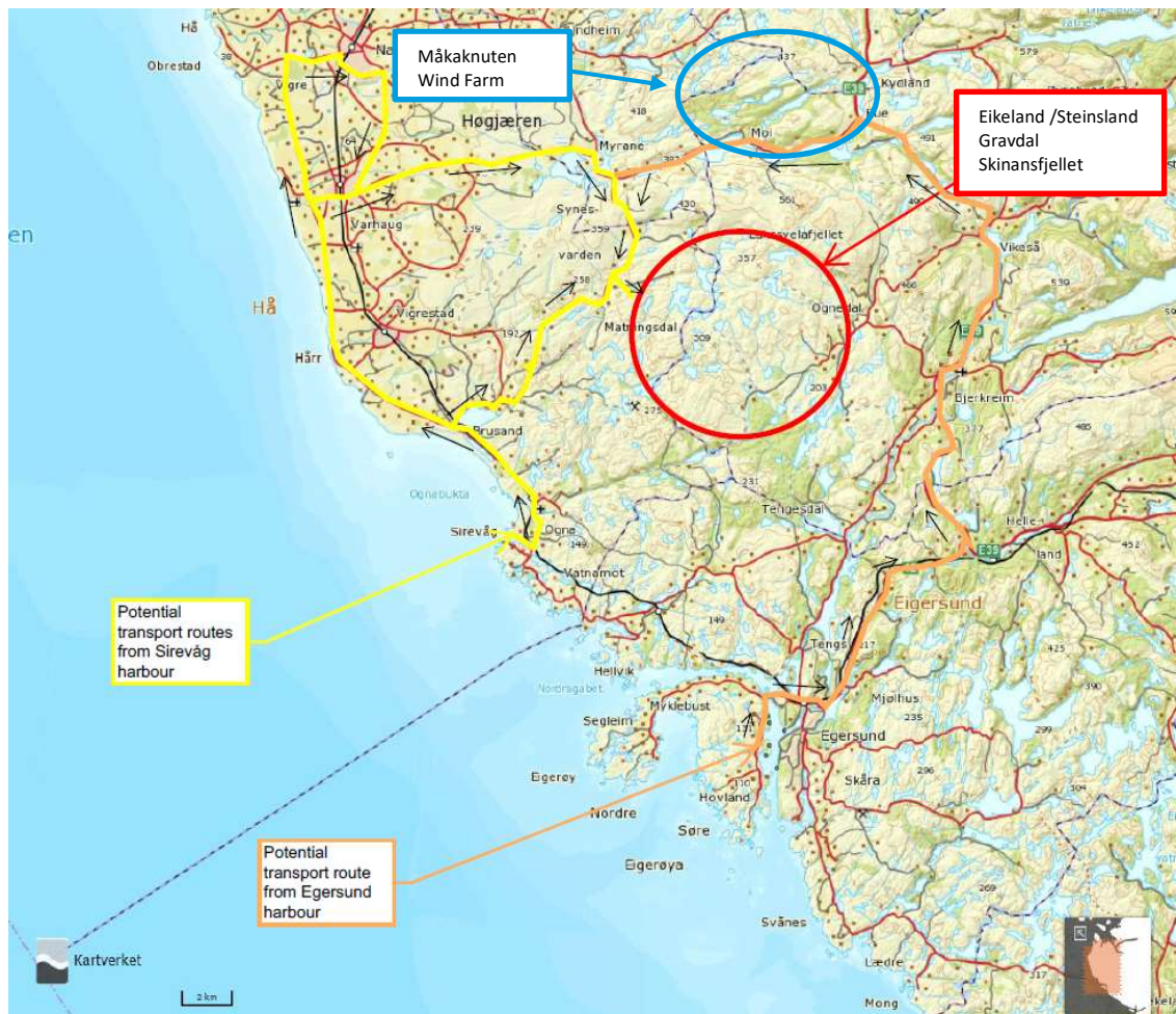
Figur 2 – Alternative transportruter for vindturbiner til Måkaknuten, Eikeland/Steinsland, Skinansfjellet og Gravdal vindkraftverk
