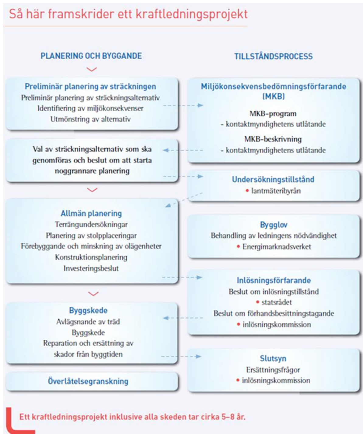
Figur 2-2. Saksbehandlingsprosjekt for en kraftledning i Finland.
