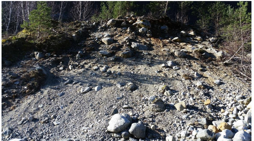
Figur 10. Øvre del av snittet er består av grov stein og blokker. Grus og sand ligger under, trolig i store mektigheter.
