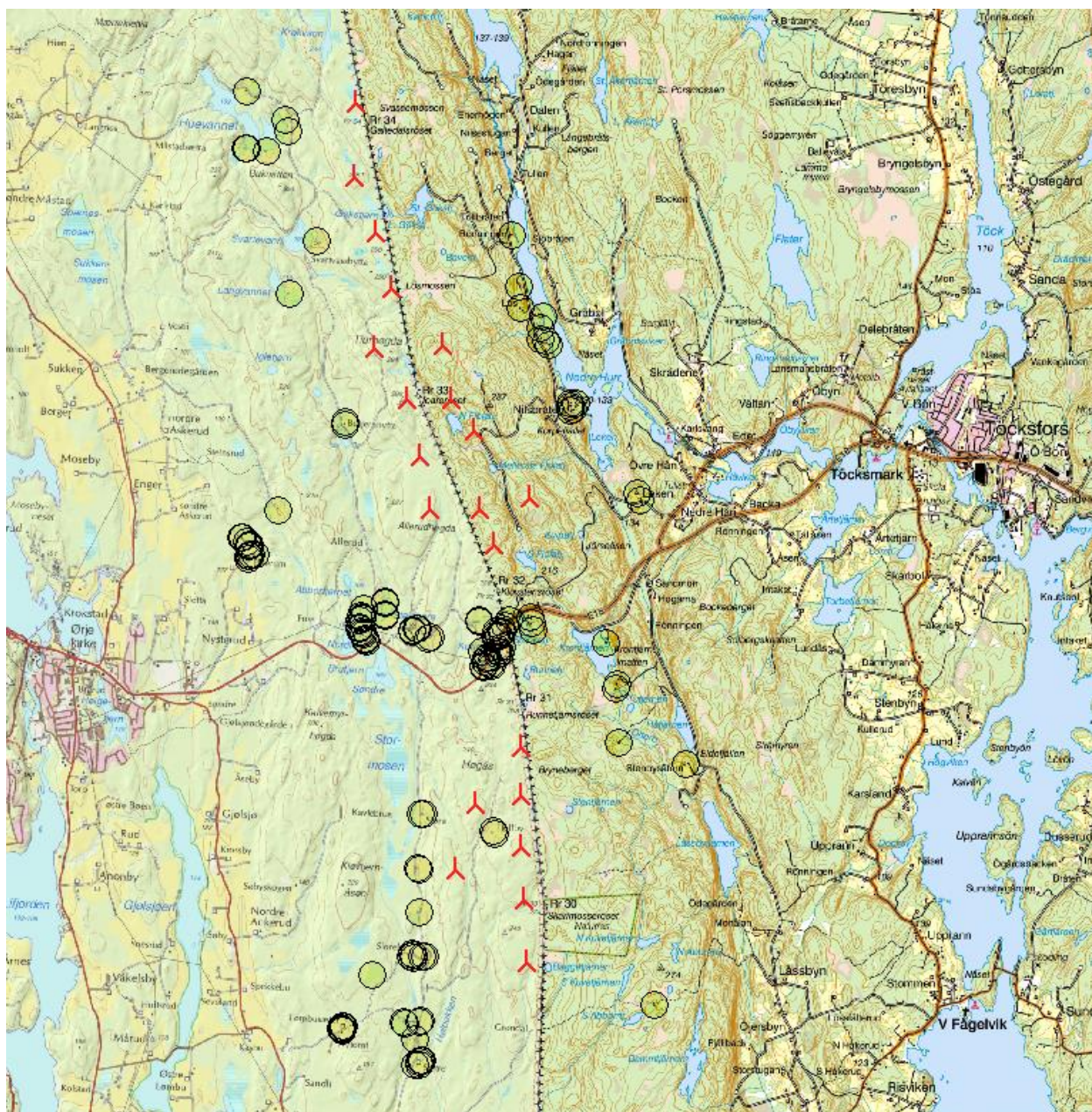
Figur 24: Reseptorer skyggekast Høgås/Joarknatten Vindpark og Hån Vindpark
