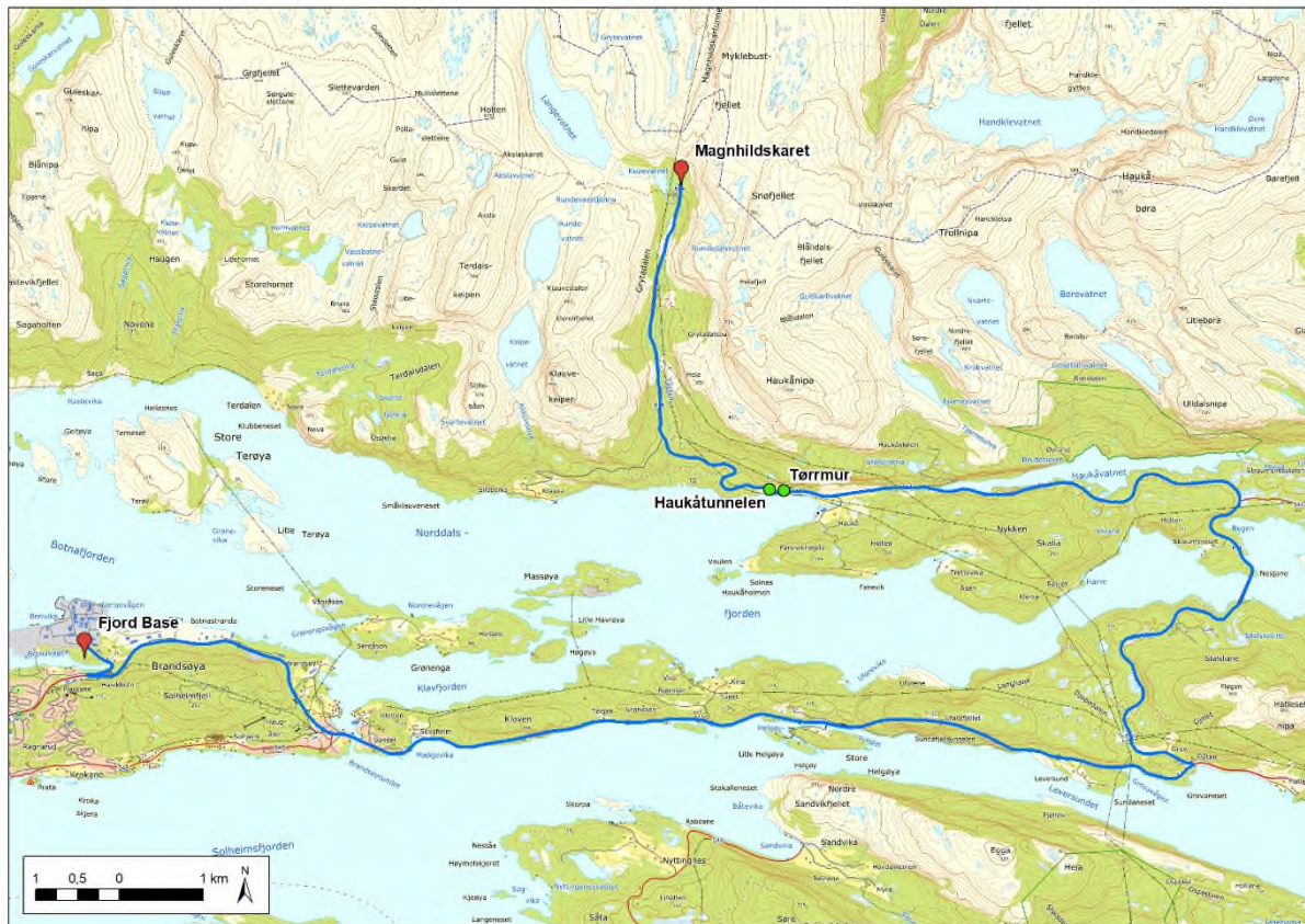
Figur 3-9 Transportruter for turbinkomponenter fra kai til atkomstveg til vindparken ved Magnhildskaret. Grønne punkter – permanente opprustingstiltak på offentlig veg
