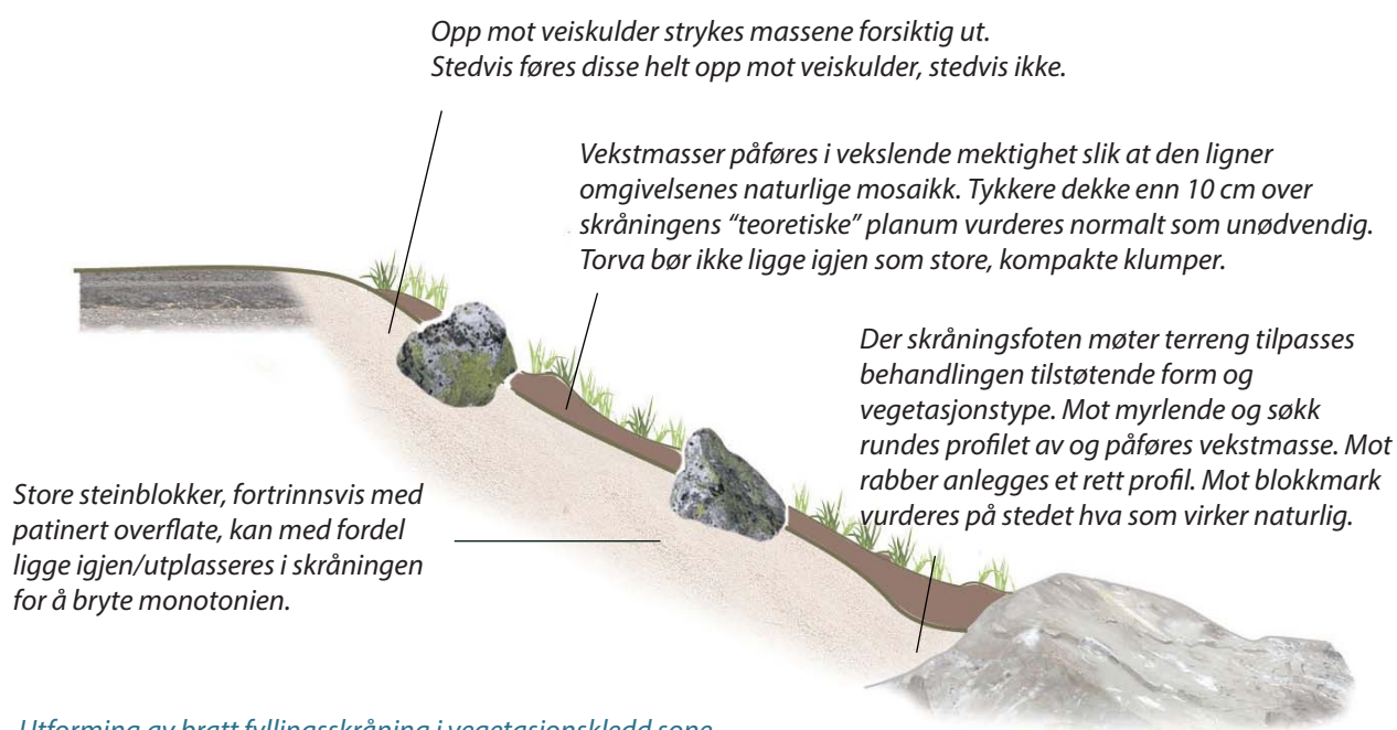
Utforming av bratt fyllingsskråning i vegetasjonskledd sone
