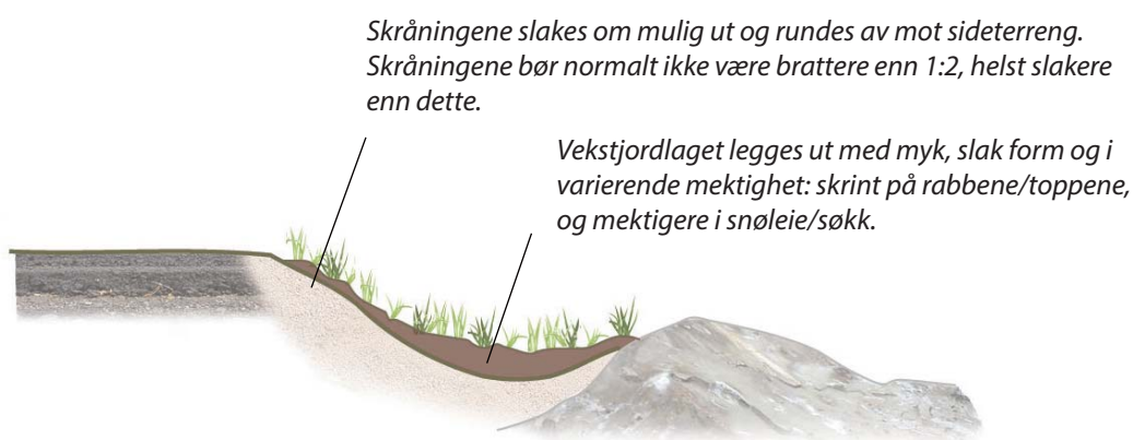
Utforming av slak fyllingsskråning i vegetasjonskledd sone
