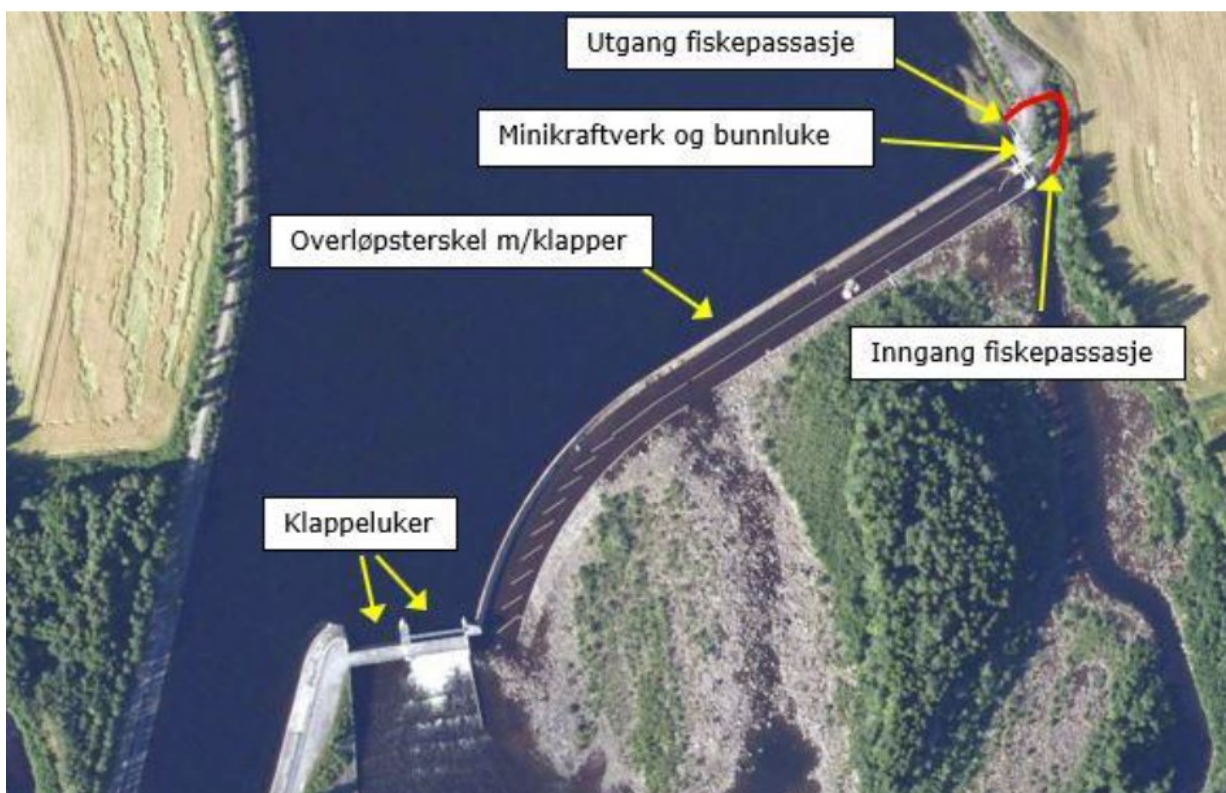
Fig 1: Oversikt over dam Strandfossen kraftverk.
