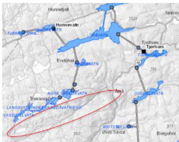
Kartet syner korleis delar av nedbørsfeltet til Skreå er overført i tunell via Smogvatn til Gravvatn. Skreådalen og Ytre Skreåvatn er ringa inn med raudt. Kartet er henta frå konsesjonssøknaden.
