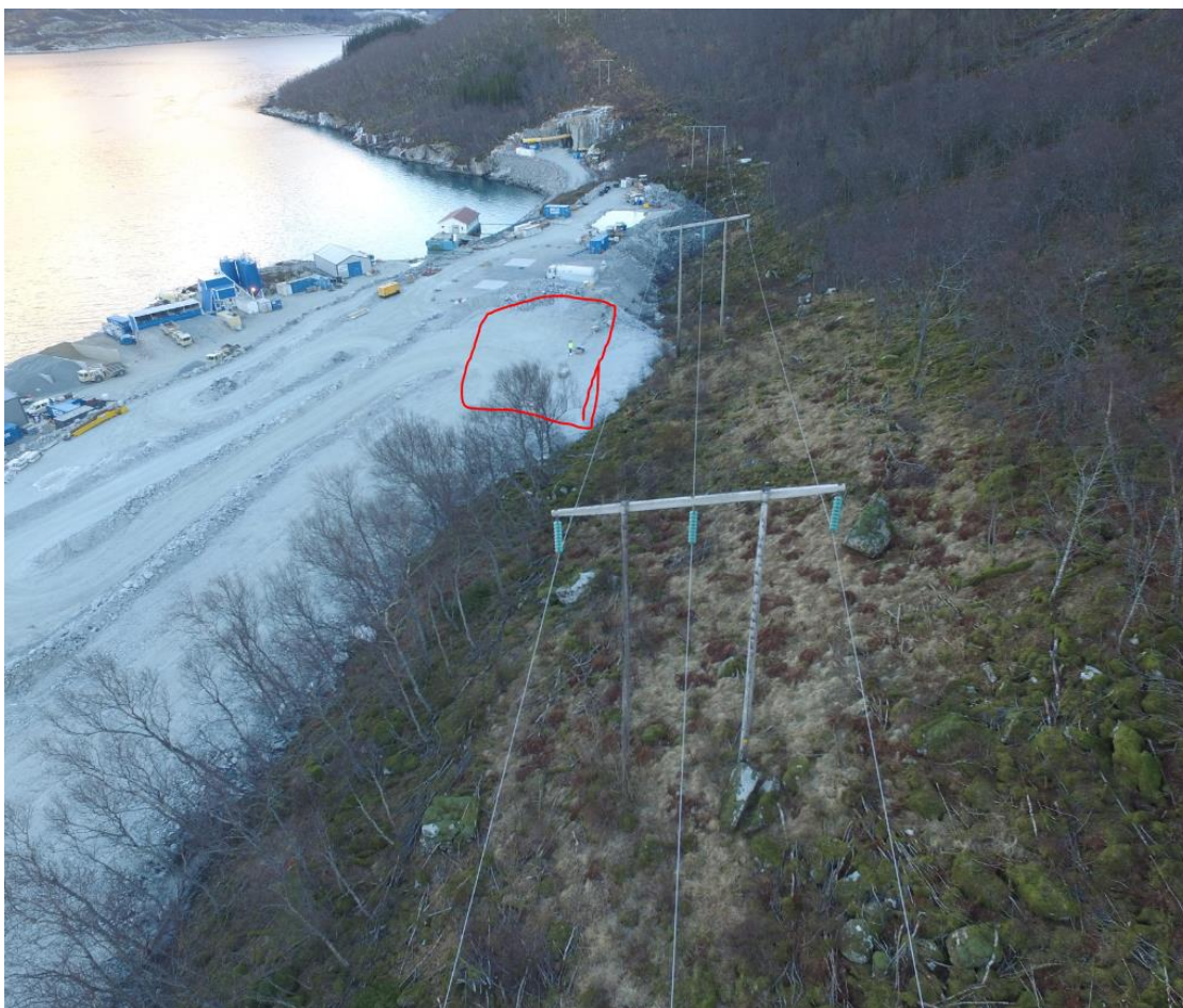
Figur 11 Koblingsanlegg plassering i forhold til eksisterende ledning
