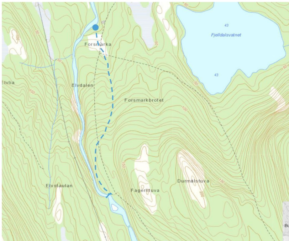
Figur 4 - Rørtrasé som tidligere konsesjonsgitt. Vedlegg 2 viser alternativ med rørgatekryssing av elv ved kraftstasjon, men det er alternativ som er konsesjonsgitt og vist i figur over som omsøkes.
