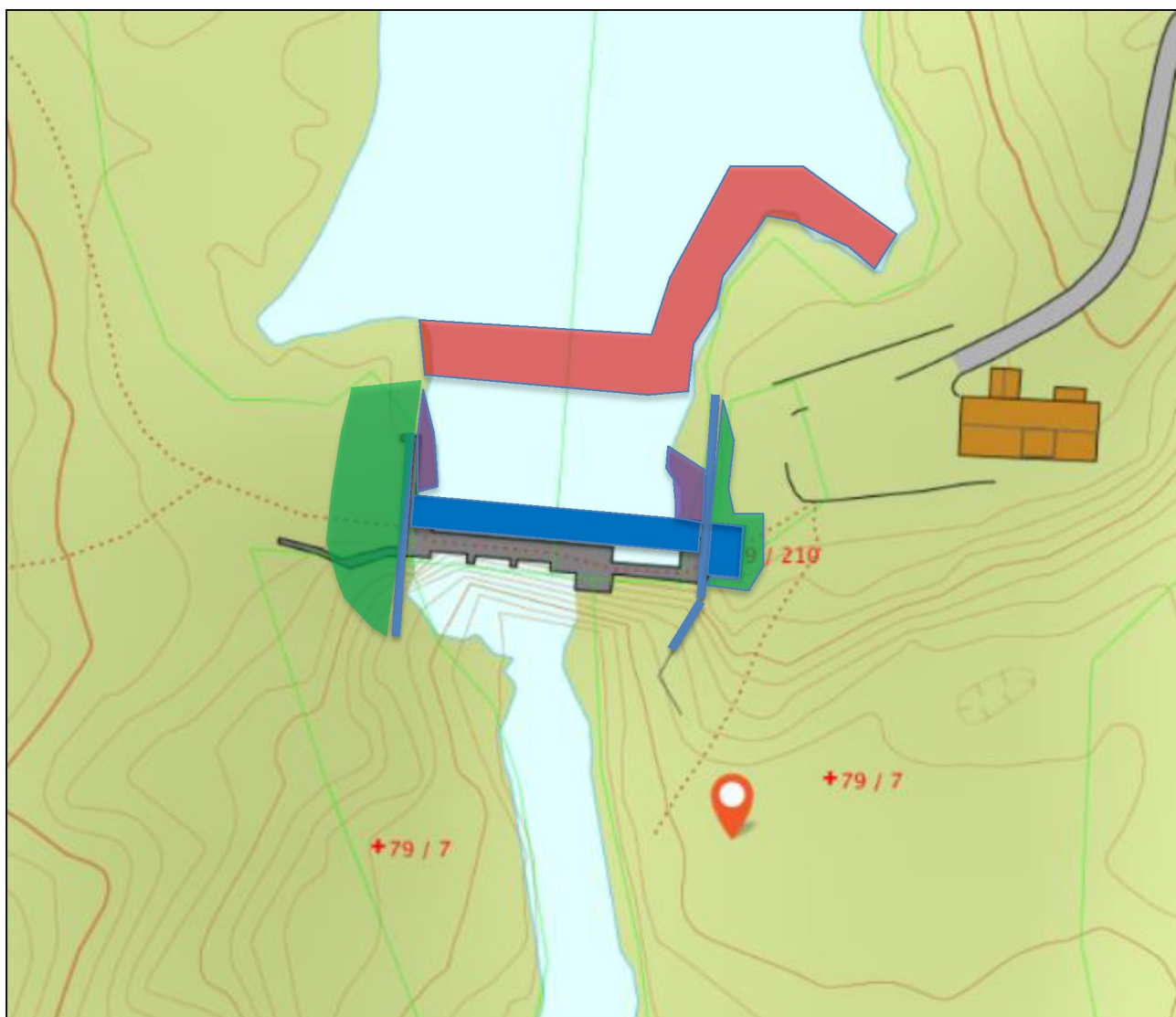
Figur 2-1 Skisse over hele rehabiliteringstiltaket. Fangdammens omtrentlige plassering (rødt). Oppstrøms påstøp, nye ledevegger og vederlag (blått). Områder som må avgraves og tilbakefylles (grønt). Fjerning av masser til HRV -0,5m (lilla). Ved venstre vederlag (øst) er det fjell og det vil måtte pigges eller sprenges forsiktig. For midlertidig nedtapping skal det kun anlegges fangdam.
