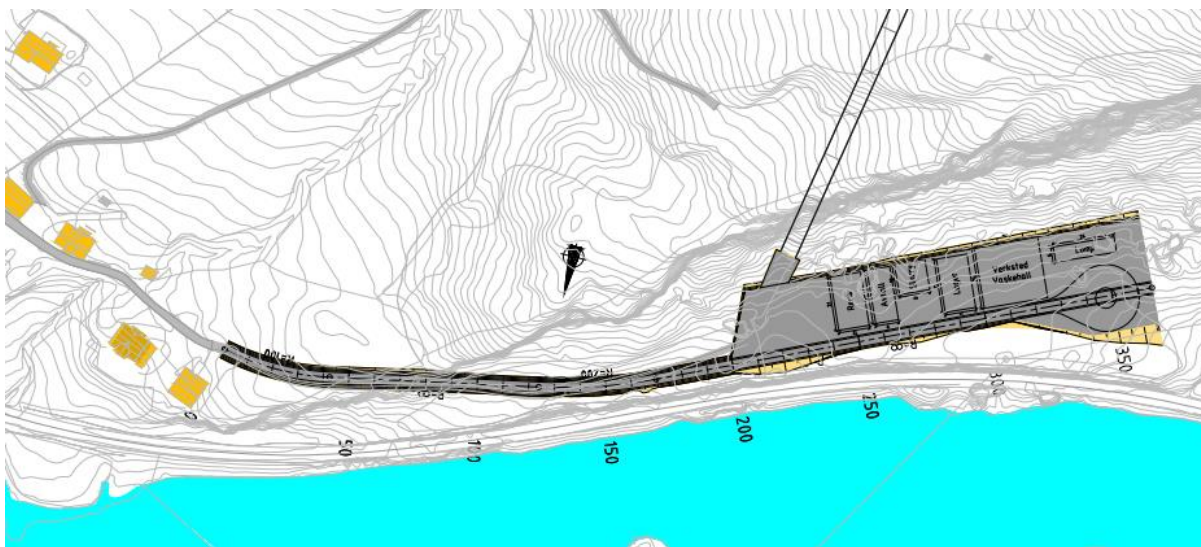
Figur 4-14 Anleggsvei, midlertidig riggområde og tverrslag Seim.
