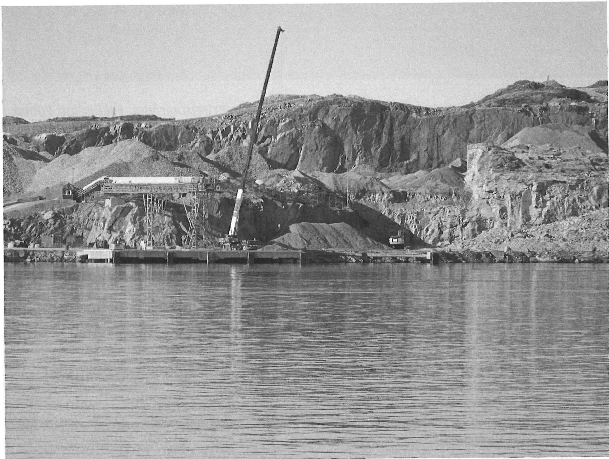
Fig.9 : Uttaksområde i eksisterende reguleringsplan. A. Vi ser lastekaien med conwayerbelte. Forekomsten er tatt ut i to pallhøyder på hver 12 m.
