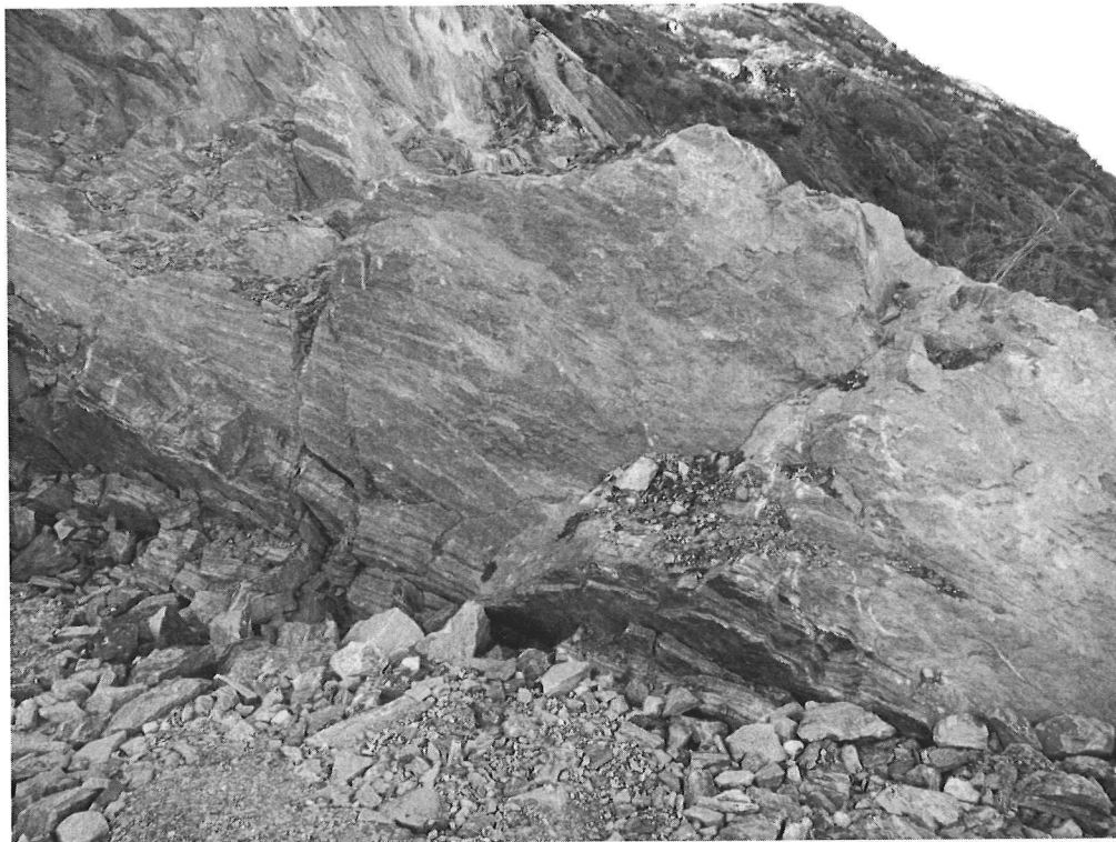
Fig.12: Berggrunn i nordlige del av den nye reguleringsplanen. Ved Rørvika. Vi har her skifrig og vitret jernholdig fjell som neppe holder mål i forhold til tekniske spesifikasjoner.
