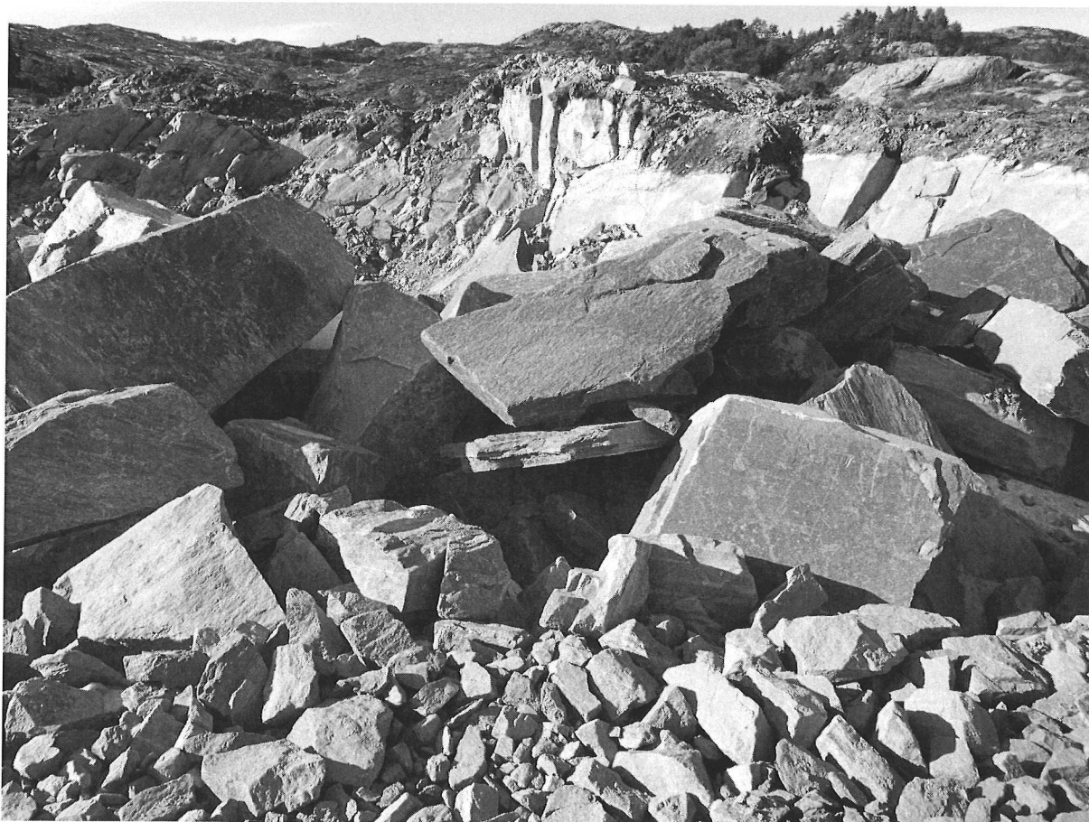
Fig. 17: Lokalitet på vestsiden av fylkesvegen. Utsprengt kubisk oppsprukket fjell som vil holde mål i forhold til tekniske spesifikasjoner til offshoreformål..
