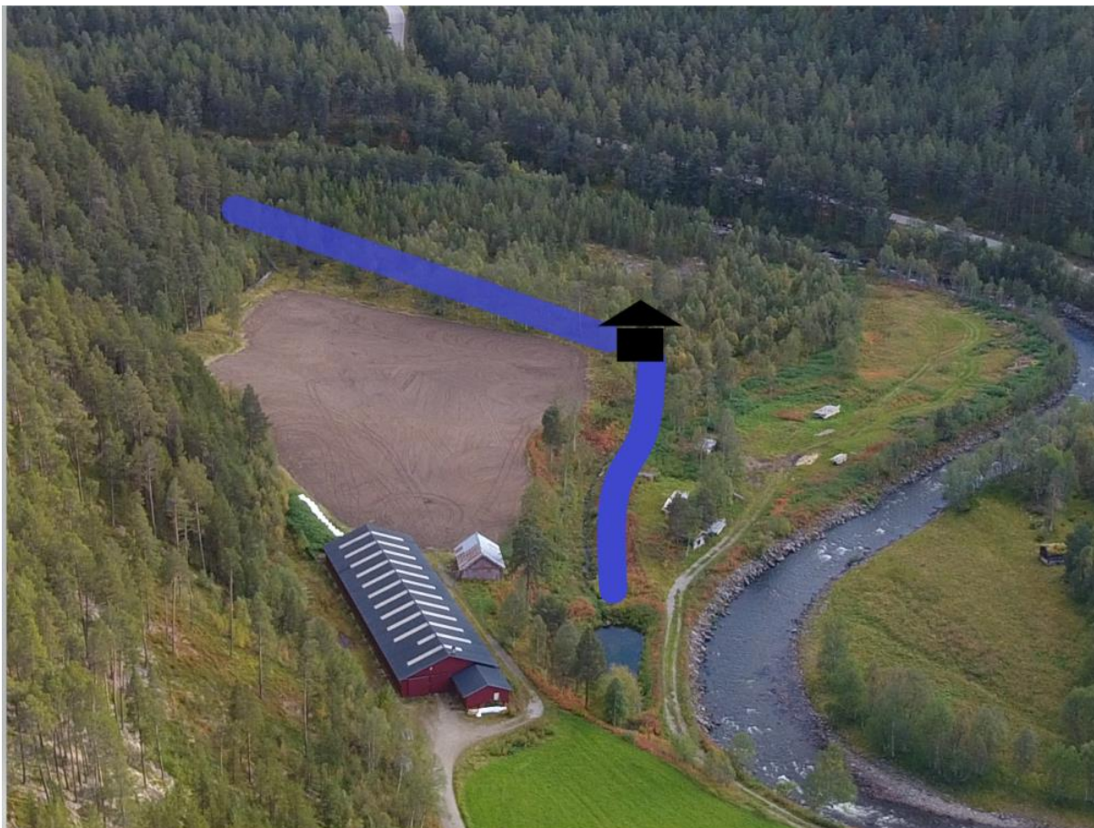
Figur 8 - dronebilde med enkle figurer. Kanal i blått og kraftstasjon i svart. Adkomstvei til stasjon blir langs kanal fra fiskedam og inn til stasjonsbygg
