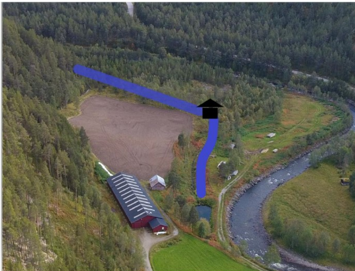
Figur 1: Omtrentlig illustrasjon av kanal, rørgate og kraftstasjon med avløp til fiskedam. Rør til fiskeoppdrett er ikke avmerket på illustrasjonen, ei heller avløpsrør gjennom gårdsveien tilbake til Nøra. Skjermdump fra søknaden.
