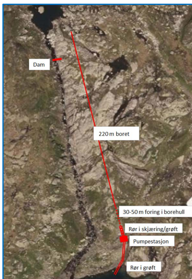
Figur 2.10. Til høyre: Utklipp fra Vedlegg 1, tegning L-005. Til venstre, øverst: Foto fra område for plassering av Blåfjellvatnet pumpestasjon ved Stora Blåfjellvatnet. T.v., nederst: Oversiktsfoto overføring fra Stora Blåfjellvatnet til Litla Gilavatnet.
