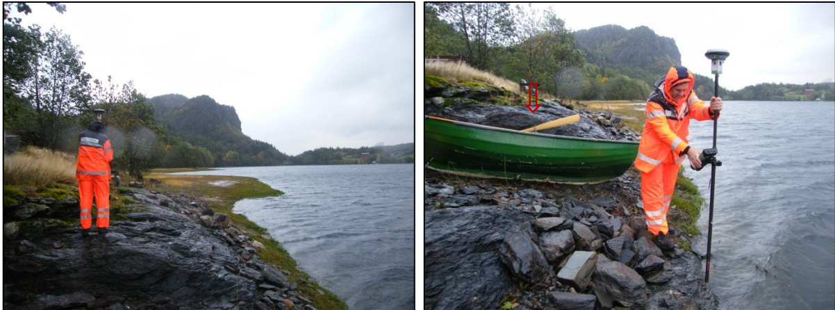
Figur 4. Kvitastein. Landmålar Magnar Dalatun måler inn målebolt (til venstre) og vasshøgda (til høgre). Målinga var tatt nokon cm lågare enn vist på bilde til høgre (raud pil viser omtrent kor målebolter er).
