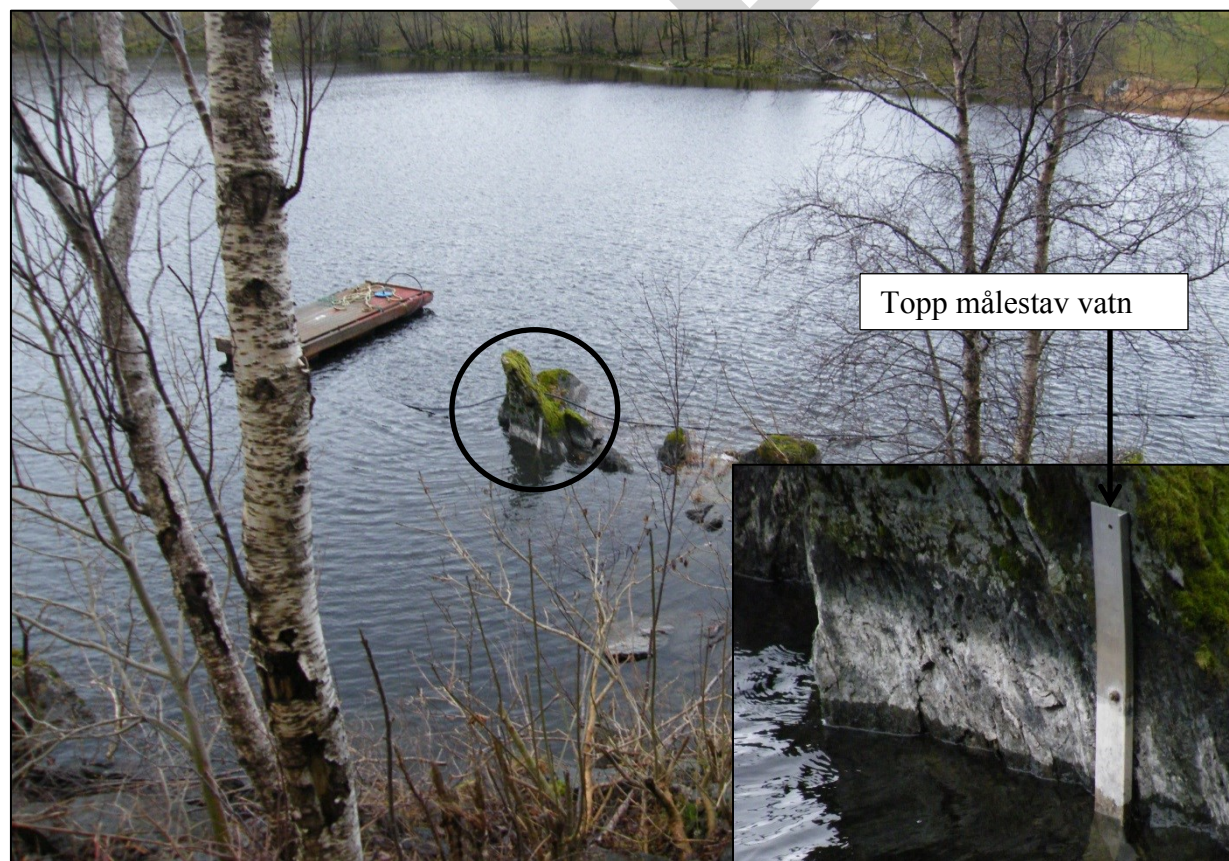
Figur 4. Målestav i vatnet. Det er toppen av målestaven er nivelert inn, ikkje markeringar på måletaven. Kor langt ned det er frå toppen av målestaven og til markert HRV og LRV er ikkje målt inn på grunn av vanskeleg tilkomst.
