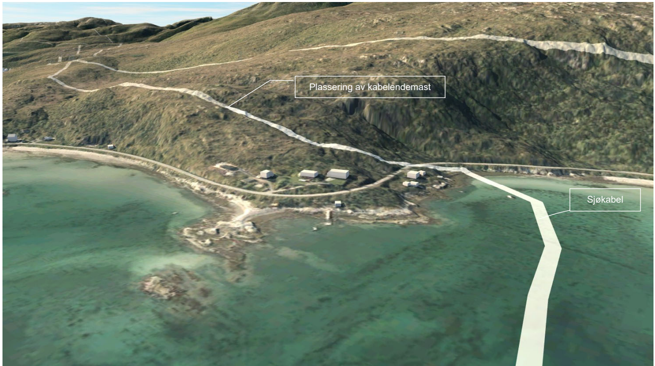
Figur 5-8. Gamvika. Landtak er foreslått kablet fra fjæra og opp til bakenforliggende fjellrygg.
